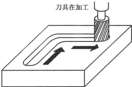
图 1-3-2 直线控制加工示意图
