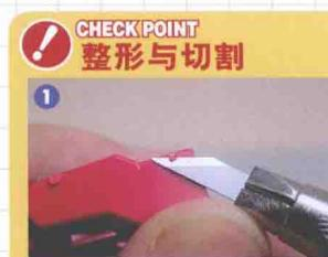
▲这是将零件残留水口切除的范例。细腻的切削和整形作业用小型笔刀最为合适。
