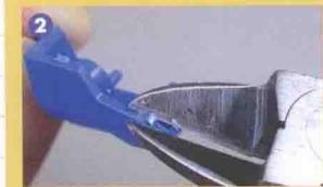
▲接下来把刀刃紧紧抵住零件，将多余的水口切除。必要的话可以在之后用砂纸打磨。
