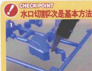
▲切割出零件。刚开始先用刀刃平整的一侧面向零件，剪断水口。留下一些多余部分进行剪断。
