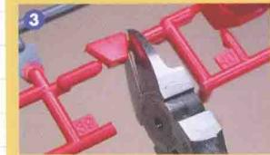
▲水口钳的刀刃不容易进行剪断的时候，可以先剪断造成影响的框架后将零件取出。
