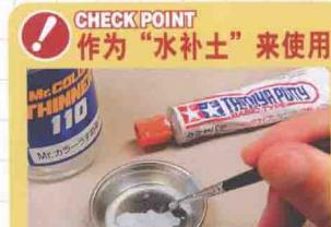
▲硝基补土不能直接用来使用，而是要添加硝基系涂料的稀释液后再使用。
