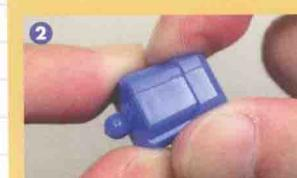
▲等塑胶被溶解后将零件紧密贴合。接缝处就会一下子冒出一些树脂。
