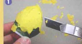
▲保丽补土硬化之后用道具和锉刀就能轻松切削来制作形状，对于零件改造是非常有用的材料。
