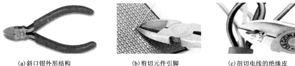
图 2-1 斜口钳的外形和用途
