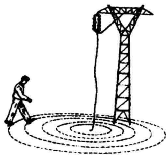
图1-4 跨步电压触电
