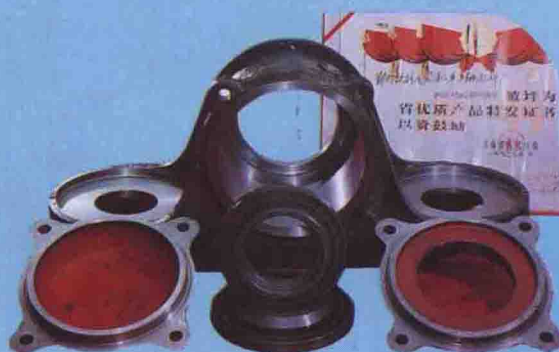
△客车整体金属迷宫密封式轴箱,已用于新造客车装配和客车检修的轴箱更新。
