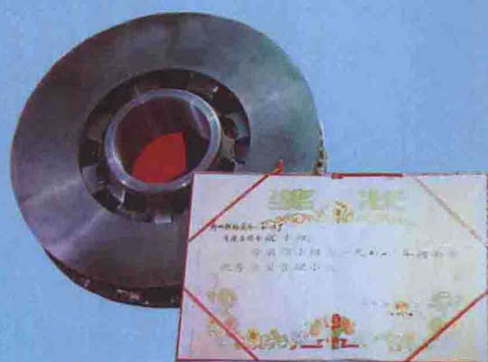
△“新型双层高速客车摩擦盘”- 盘型制动装置,国家“七五”期间科研项目,现批量生产。
