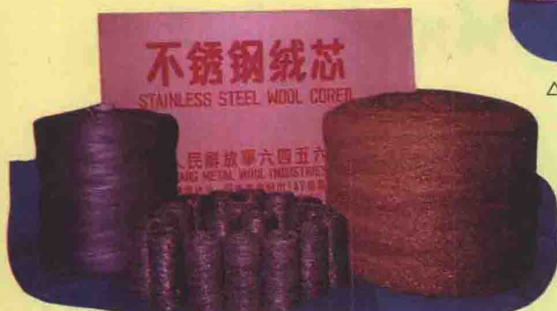
△该厂引进法国设备和技术生产的消声器芯,填补了国内空白,被国家冶金部定为部颁标准。中汽公司列为“八五”行业规划。
