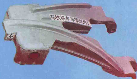
△LF1 型高强度铝合金复轨器,适用于铁路 43K9/m 至 75K9/m 型钢轨木枕,混凝土轨枕线路各类内燃、电力、蒸气机车和车辆脱线起复使用,目前已批量生产,以替代铸钢复轨器。
