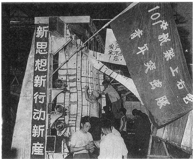
青年突击队正在加班装配歼教1飞机右机翼
