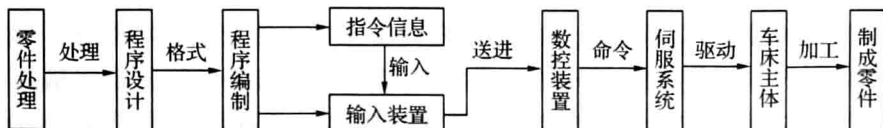
图 1-3 数控车床的工作过程
