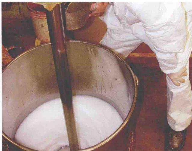
将水、溶剂和增稠剂混合
