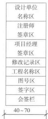
图 1-3 标题栏示意图 (一)
