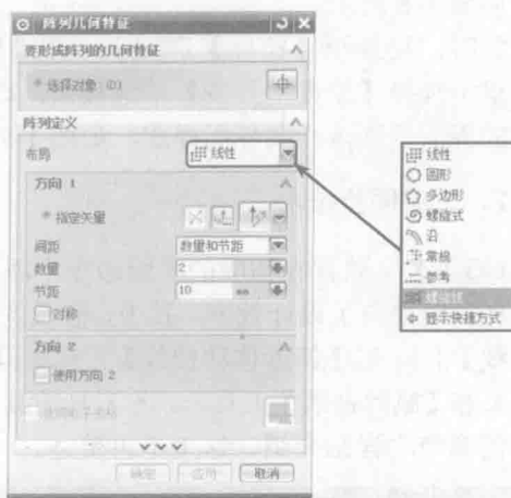
图 1-11 【螺旋线】阵列方式
