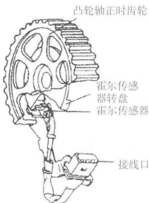
图 1-9 捷达轿车凸轮轴位置传感器外形图
