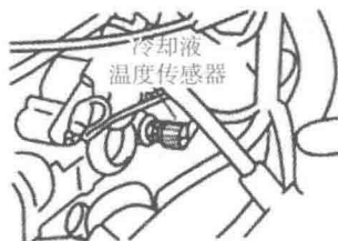
图 1-13 冷却液温度传感器安装位置
