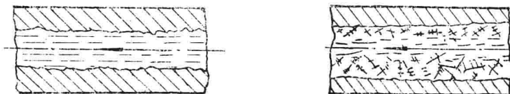
a—纯金属和共晶合金的凝固层 b—有结晶间隔的合金凝固层 图 1—6 合金凝固层示意图
