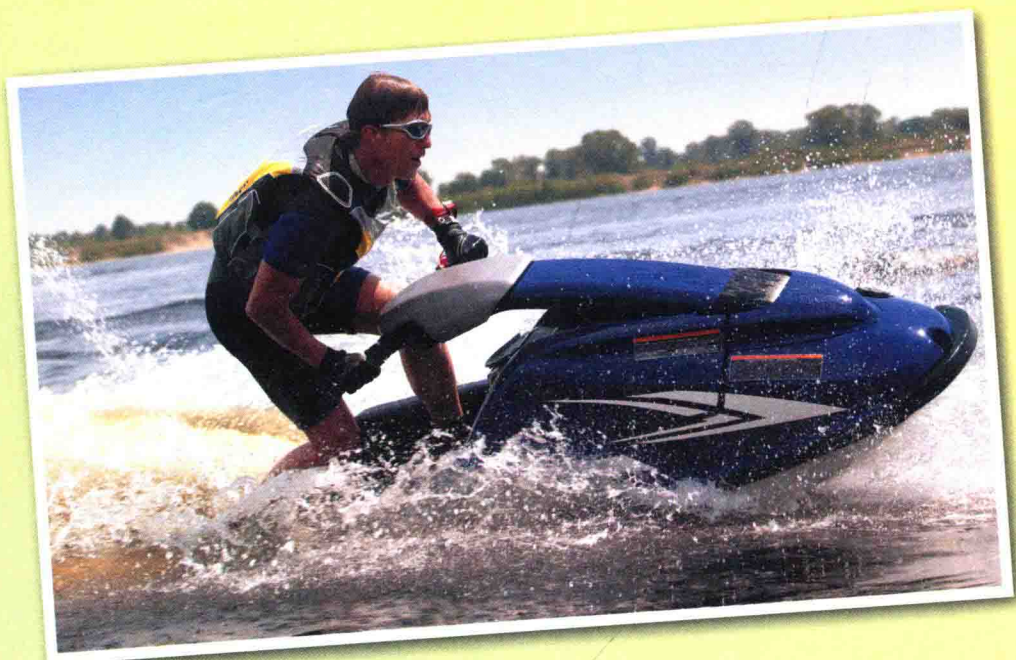
摩托艇靠喷水推进器在水上飞驰。
