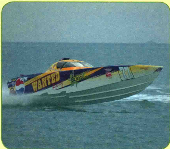
这艘船的深 V 形船体有利于划水，高速航行。
