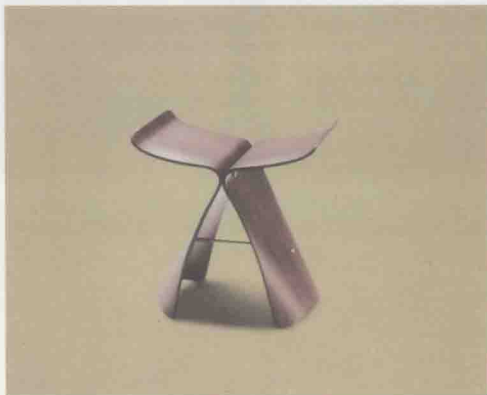
图 1-1-2 日本大师柳宗理设计的蝴蝶凳, 该作品获得 1957 年米兰设计大赛金奖。他采用两块高频弯曲成型的胶合板, 制作出具有独特造型的蝶形凳, 高水平地发挥了成型的优点, 成为融合设计与技术的典范。
