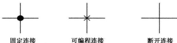
图 1-3 交叉线的连接形式
