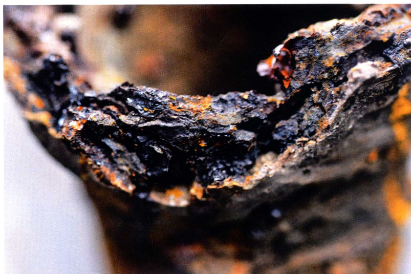
图 1.14 器身内部水泡状点腐蚀
