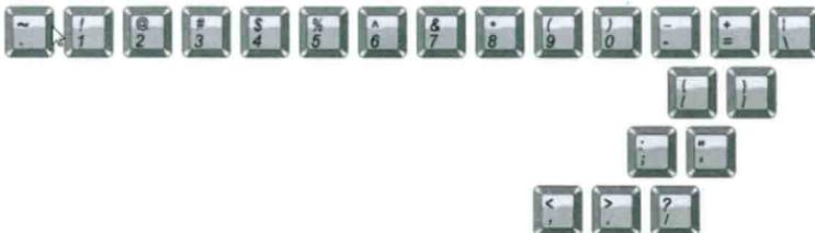
在数字与符号键的键面上，上面的符号称为上挡字符，下面的符号称为下挡字符，主要包括数字、标点符号、运算符号和其他符号。如果直接按下数字与符号键，会输入相应键的下挡字符，即对应的数字或符号；如果按住“Shift”键的同时再按下数字与符号键，会输入上挡字符。
