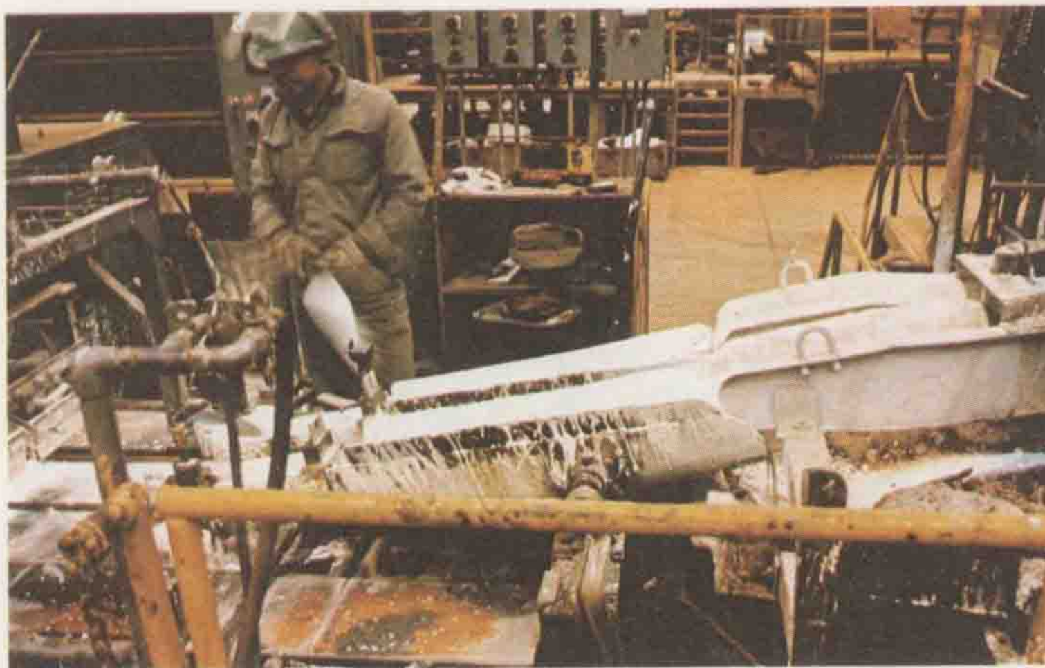
亜鉛の精製 電解工場からの精製亜鉛を鋳造し、インゴットとする
