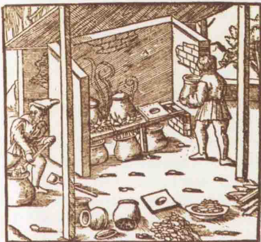
蒸留によって黄鉄鉱からイオウをつくる図(『デ・レ・メタリカ』の挿絵より)
