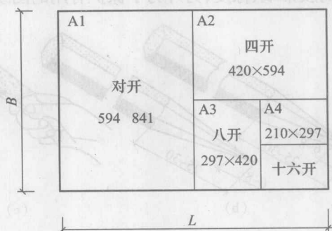
图 1-9 各种图纸基本幅面的尺寸关系
