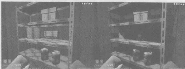
图 1-4 Shadow Volume (阴影锥) 关闭 (左) 与开启 (右) 的效果对比
