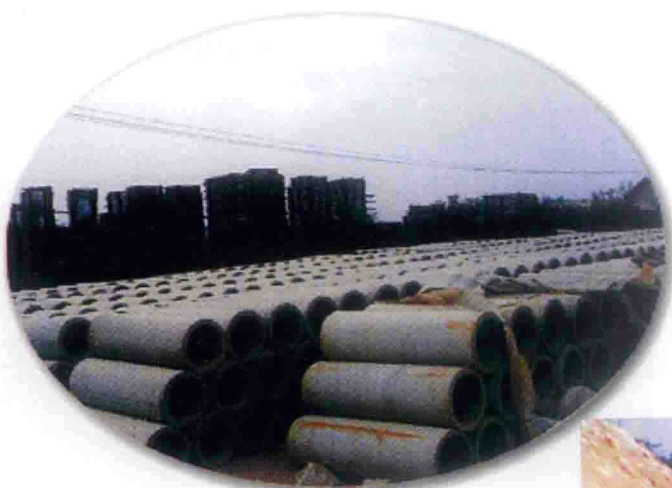
现代路桥工程总 公司30厘米混凝土压力 管预制场
