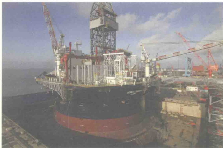
中远船务启东海工基地的圆筒型超深水海洋钻探平台“希望3号”
