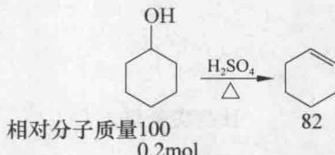
根据化学反应式，1mol 环己醇能产生 1mol 环己烯，今用 20g（即  $20/100=0.2\text{mol}$ ）环己醇，理论上应得到 0.2mol 环己烯，理论产量为  $0.2 \times 82=16.4\text{g}$ ，但实际产量为 12g，所得百分产率为  $\frac{12}{16.4} \times 100\% = 73\%$ 。
