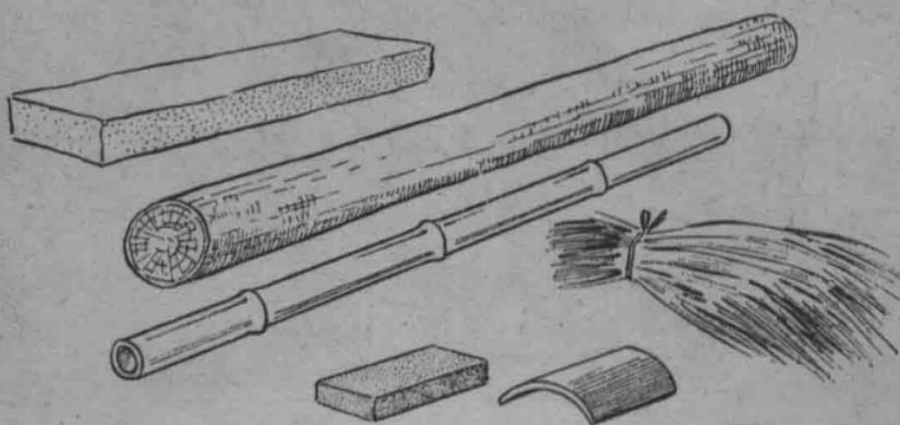
振中問：「造屋要用些什麼東西？」強中說：「造茅屋要用稻草、蘆葦或大竹；造木屋用樹榦或木板；造瓦屋用木、石、瓢瓦、石灰等許多材料；造大厦用鋼架、水泥、石子，有時也用些木、石、瓢瓦；此外鉛皮、玻璃、油、漆等，都是造屋的必需材料。」
