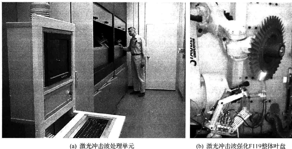
图 1.3 美国金属改性公司激光冲击波装备 [6]
