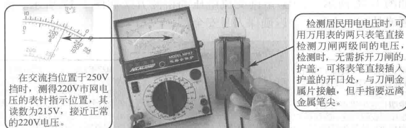
图 1-17 220V 市网交流电压的检测方法
