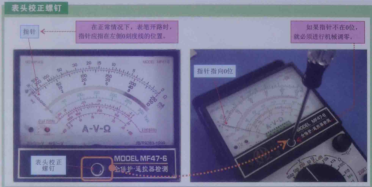
【图1-4 表头校正螺钉】
