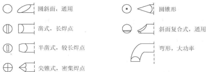
图 1-1-2 常用烙铁头的形状
