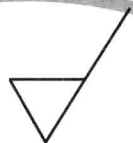
图 2 表示去除材料的扩展图形符号
