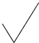
图 1 表面结构的基本图形符号
