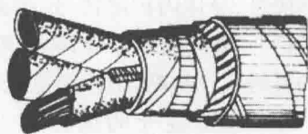
图 1.2 油浸纸绝缘钢带铠装电缆结构图
