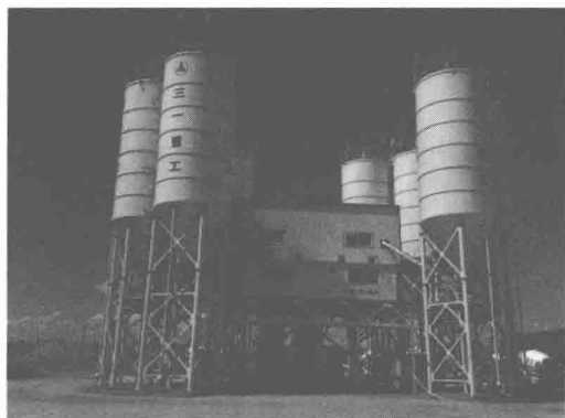
图 0-31 水泥混凝土拌合站
