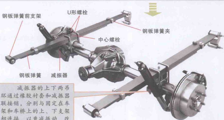
钢板弹簧式非独立悬架组成结构图
