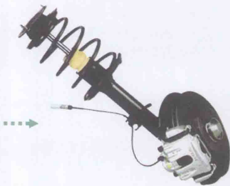
液力式减振器实物外观
