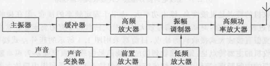
图 1.2 无线电调幅广播发射机原理框图
