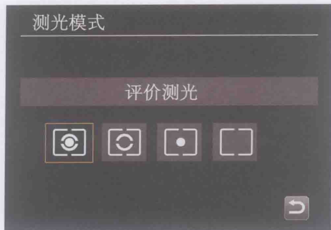
图1-4 测光模式（从左到右）：评价测光、局部测光、点测光和中央重点平均测光。
