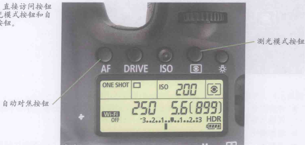
图1-3 主拨盘和调整设置时需要使用的其他控制按钮。
