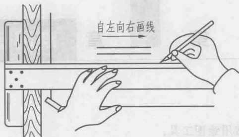
图 1-2 丁字尺与图板配合画水平线
