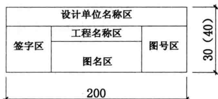
图 1-2 图纸标题栏
