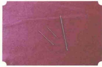
手缝针 (最长的那根针是用来缝制玩偶类布艺的, 其他两根是用来缝合边的)
