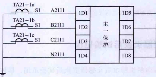
图 1-1-13 电流互感器二次回路接线图
