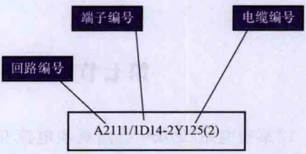
图 1-1-14 控制电缆上的电流回路标注
