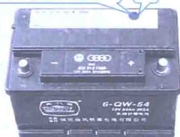
检查电解液液面高度
