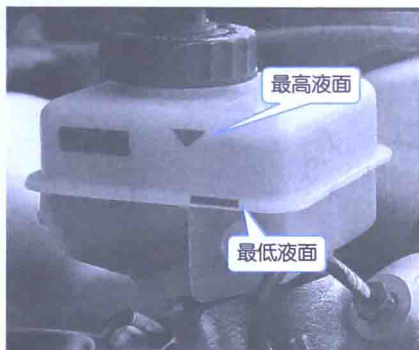
检查制动液液面高度
