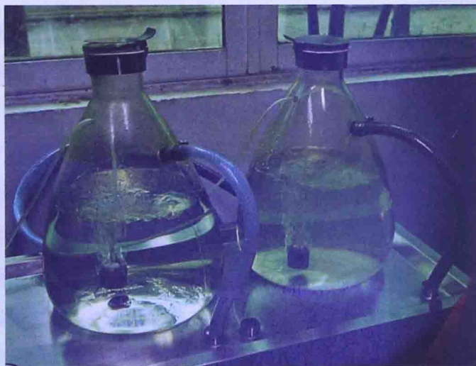
图1-1 原水、出厂水嗅味检测装置
