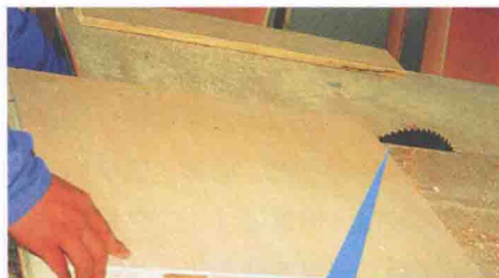
裁切木质板材务必在木工操作台上施工，能有效保证切割精度与安全性。
