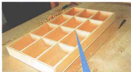
合理地柜体构造是纵向板材保持通直，横向板材被纵向板材断开。
