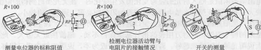
图 1-7 电位器测量
