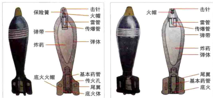
八路军造 82mm 迫击炮榴弹 (弹径 81.1mm) (左); 八路军造 82mm 迫击炮榴弹 (弹径 81.5mm) (右)
