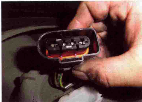
图 1-4 用万用表测量燃油泵插接器插头上端子 1 和端子 4 之间的工作电压
