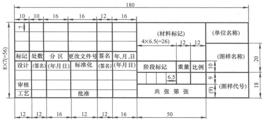
图 1-4 标题栏的内容、格式及尺寸
