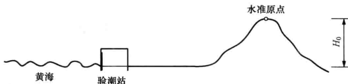
图 1-8 水准原点的高程确定
