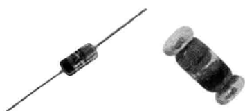
图 1-4-3 1N4148 二极管(左插件右贴片)
