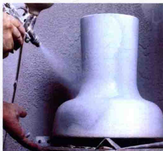
3. 喷釉法需要较多装备：喷枪、压缩机、防尘面罩等，简化时可用吹釉壶人工完成。
