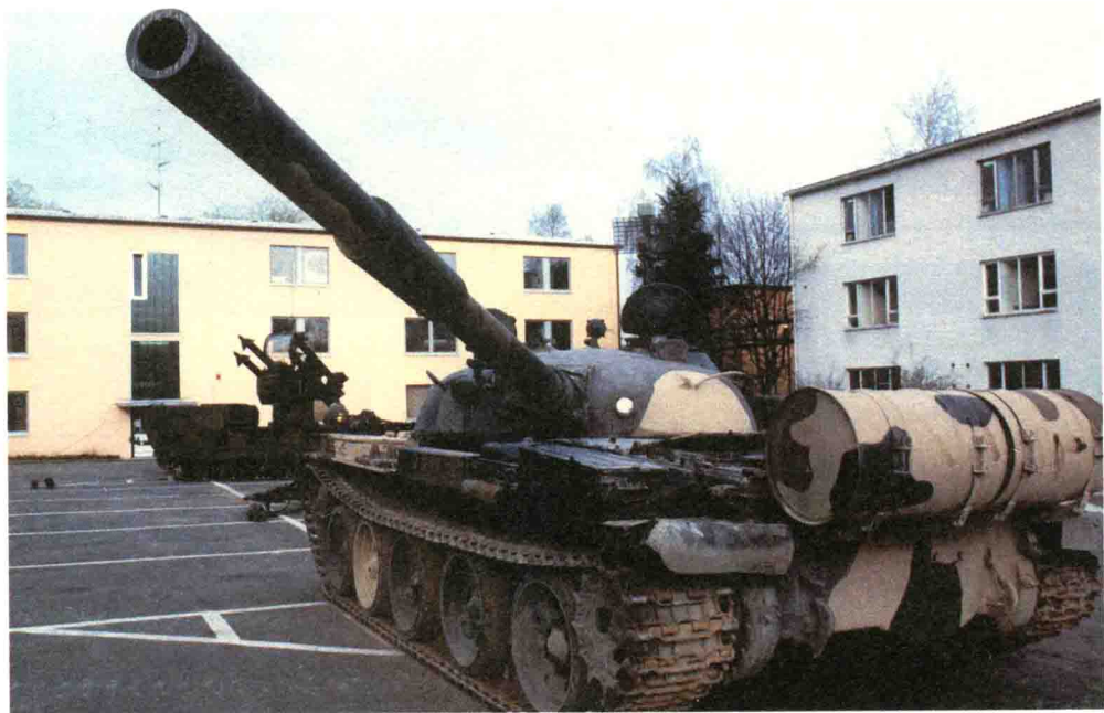
上图：图中的 T-62 坦克外表画着斑驳的掩饰花纹，其 115 毫米（4.5 英寸）口径 U5TS 滑膛式榴弹炮给人带来一种不祥之感。注意其武器炮筒外面的隔热套管以及尾部额外安装的燃料箱。
