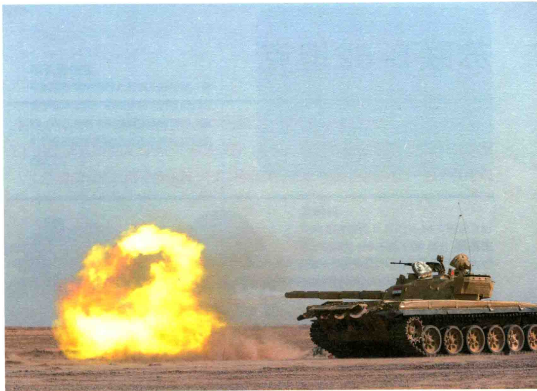
上图：一辆伊拉克的T-72坦克正在演习中发射125 毫米（4.9 英寸）口径的炮弹。T-72坦克及其变体车型的生产数量比其他任何坦克都多，在后来的多次升级改造中，它们一直都在服役。
