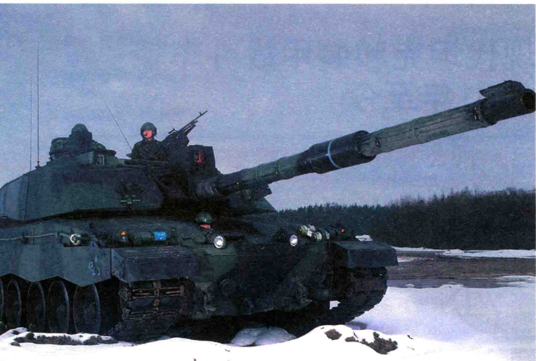
上图：英国“挑战者”2型主战坦克最开始时装备120毫米（4.7英寸）口径的L30线膛炮。其设计中的创新之处在于融合了“挑战者”1型中的诸多部件。
