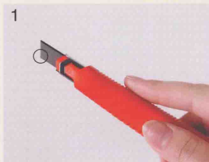
图中画圆圈的裁纸刀的刀背部分抵在纸上，画出痕迹。
