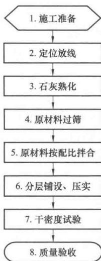
图 1-3-1 灰土地基施工流程图
