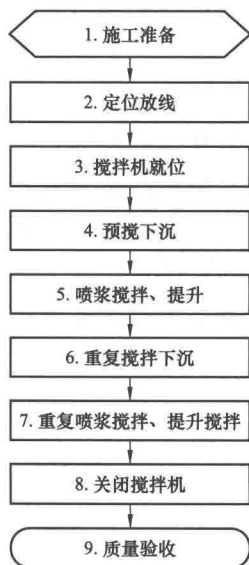
图 1-4-1 水泥土搅拌桩地基施工流程图
